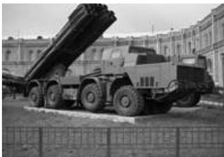
300-мм реактивная система залпового огня 9К58 «Смерч» предназначена для поражения живой силы, бронированной и небронированной техники на марше и на позициях, артиллерийских батарей, командных пунктов, узлов связи, уничтожения ВПП аэродромов и других целей
